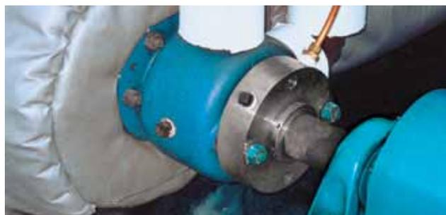
Para la transferencia a baja presión de asfaltos mezclados limpios o rebajados, Viking ofrece bombas de asfalto de propósito general encaquetadas. El rotor “flotante” en estas bombas es un diseño simple y económico.
