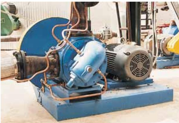
Para las aplicaciones de refinería, alta presión, asfaltos cargados con materia inerte y emulsiones, las bombas encaquetadas de uso intensivo de Viking® cuentan con un rodamiento de empuje que fija la posición del rotor en el cabezal, para que los usuarios puedan ajustar espacios finales precisos y compensar el desgaste con el paso del tiempo. Entre las opciones para estas bombas duraderas se encuentran:
