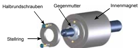
ABBILDUNG 13 INNENMAGNET UND GEGENMUTTER
