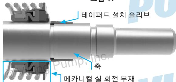
**주의사항:** 조립하기 전에 회전자 축, 테이퍼드 설치 슬리브 및 메카니컬 실의 내경을 P-80® 또는 동종 제품으로 코팅합니다.
